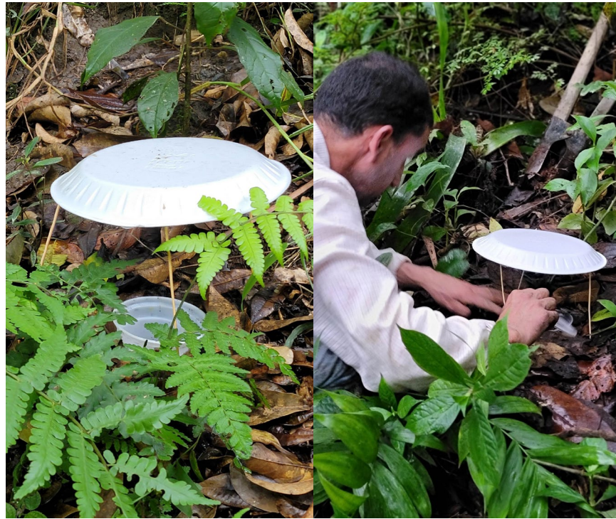
Figura 2. Trampa de caída tipo Pitfall con envase de 600 ml de polipropileno y su instalación en campo.
